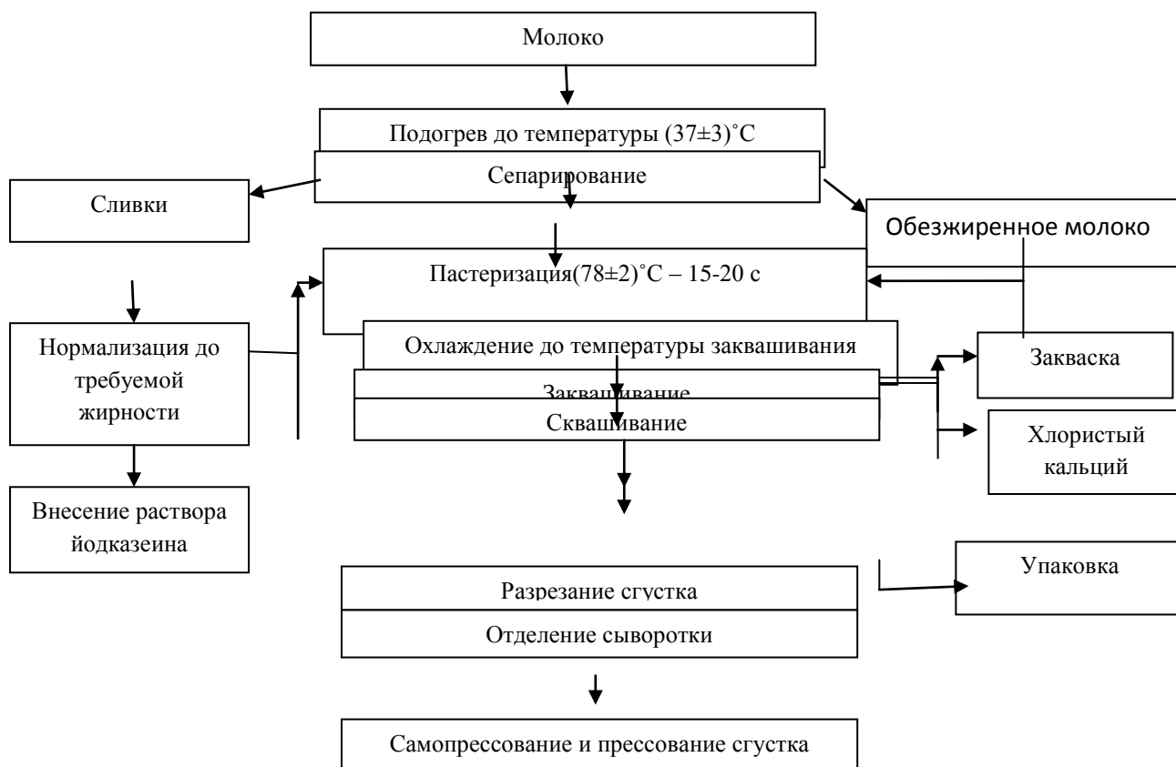
Рисунок 1 – Схема технологического процесса производства творога
