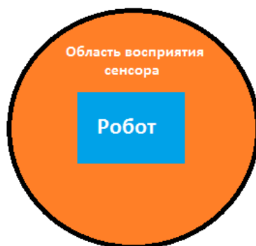
Рис. 7. Область восприятия ультразвукового датчика внутри окружности
