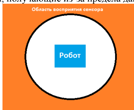
Рис. 8. Область восприятия ультразвукового датчика за пределами окружности.
