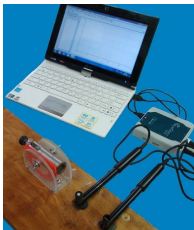
Рис. 13. Определение начальной скорости полета пули с использованием датчиков магнитного поля
