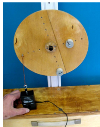
Рис. 12. Экспериментальная установка для изучения условия равновесия рычага
