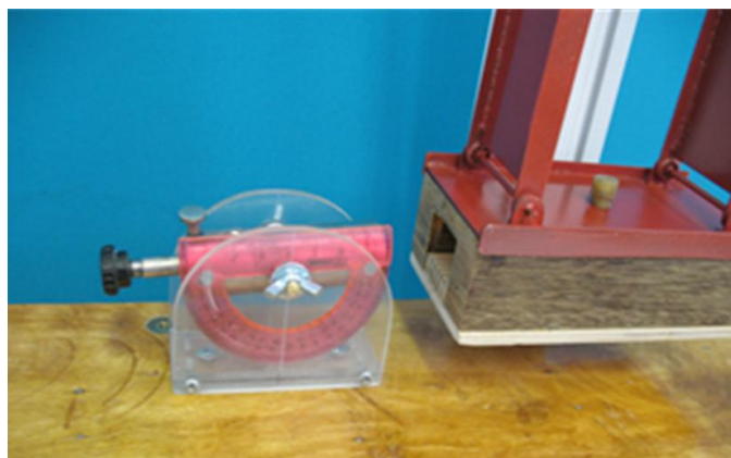
Рис. 11. Экспериментальная установка для изучения взаимодействия пули, вылетевшей из пружинной пушки, с физическим маятником
