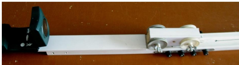
Рис. 48. Установка для изучения движения легкоподвижной тележки по горизонтальной поверхности
