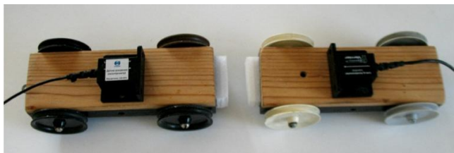
Рис. 35. Датчики ускорения на тележках
