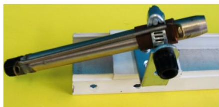
Рис. 42. Пружинный пистолет для стрельбы под углом к горизонту
