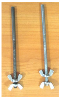
Рис. 7. Стержни для крепления навесных конструкций
