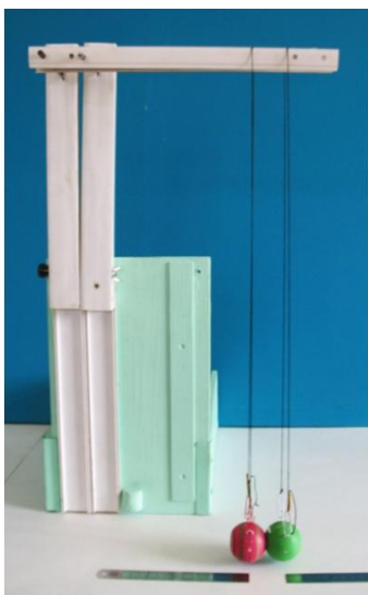
Рис. 45. Установка для изучения упругого и неупругого ударов
