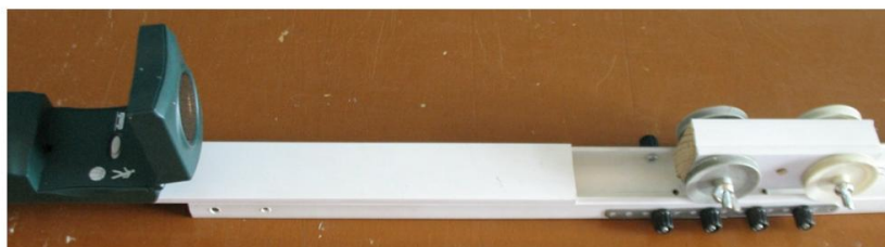
Рис. 33. Тележка на треке в зоне действия датчика расстояния
