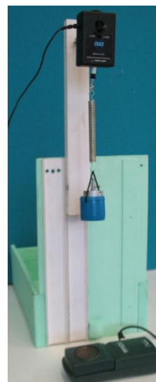
Рис. 47. Установка для изучения деформации пружины и колебаний пружинного маятника
