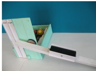
Рис. 49. Установка для изучения движения бруска по наклонной плоскости
