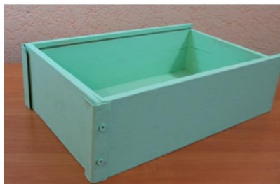
Рис. 5. Уголки на короткой торцевой стороне ящика для крепления выдвигной крышки
