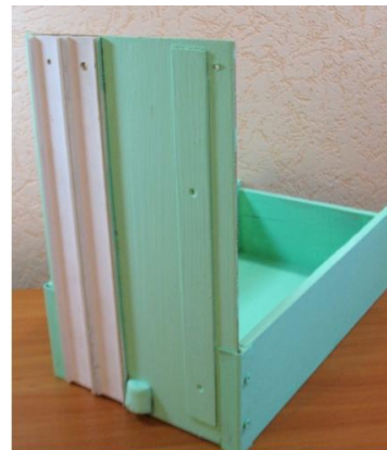
Рис. 6. Крышка, вставленная в щелевидное отверстие между уголками и стенкой ящика
