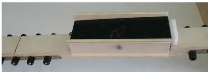
Рис. 30. Брусочек с ограничителями на наклонном треке
