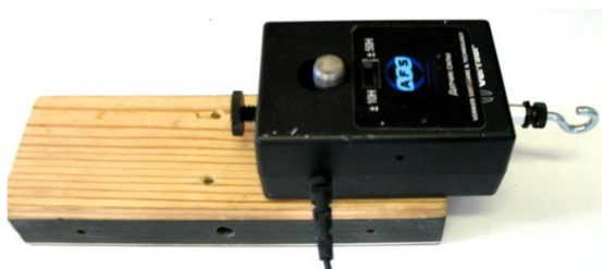
Рис. 37. Датчик силы, укрепленный на штыре
