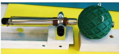
Рис. 43. Пружинный пистолет для стрельбы в шар, закрепленный на бруске
